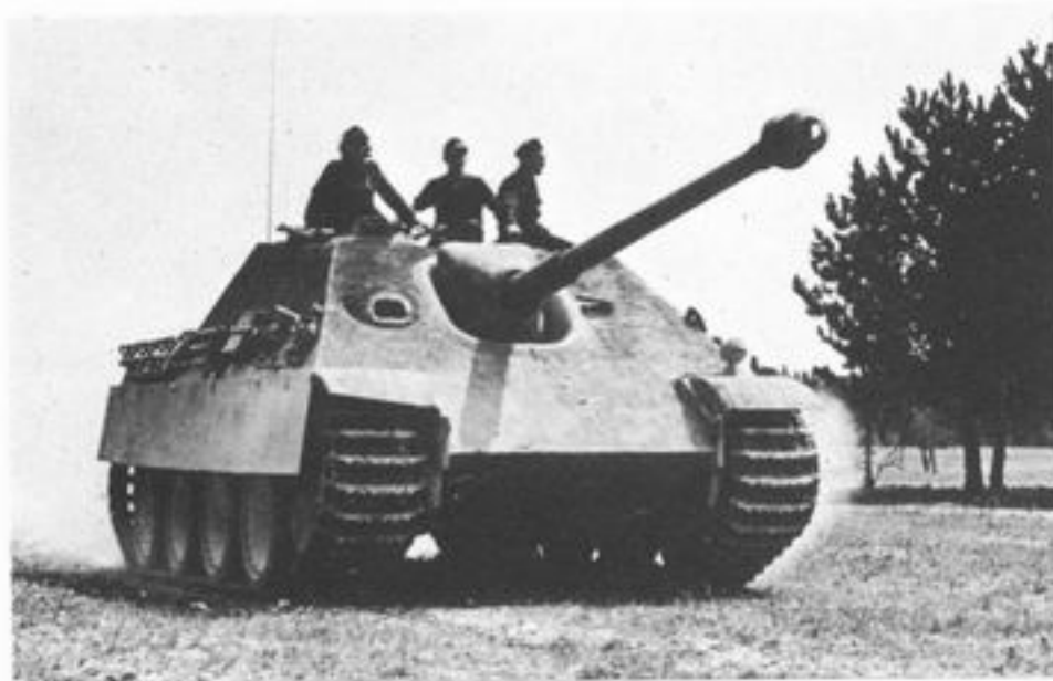
8,8cm Pak 43/3 auf Panzerjaeger Panther SdKfz 173s or Jagdpanther
