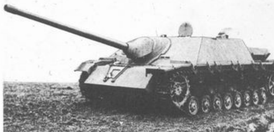
Left Panzer IV/70 SdKfz 162/1 or Jagdpanzer IV mit 7.5cm StuK 42 L/70
