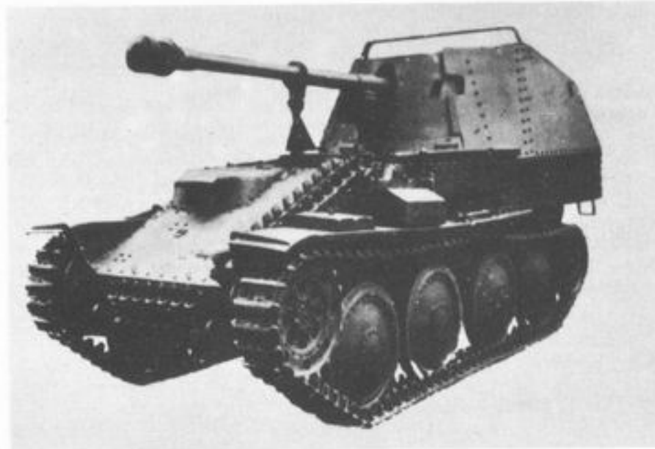
Panzerjaeger 38(t) Ausf. M SdKfz 138 or 7,5cm Pak 40/3 (L/46) Marder III auf GW 38
