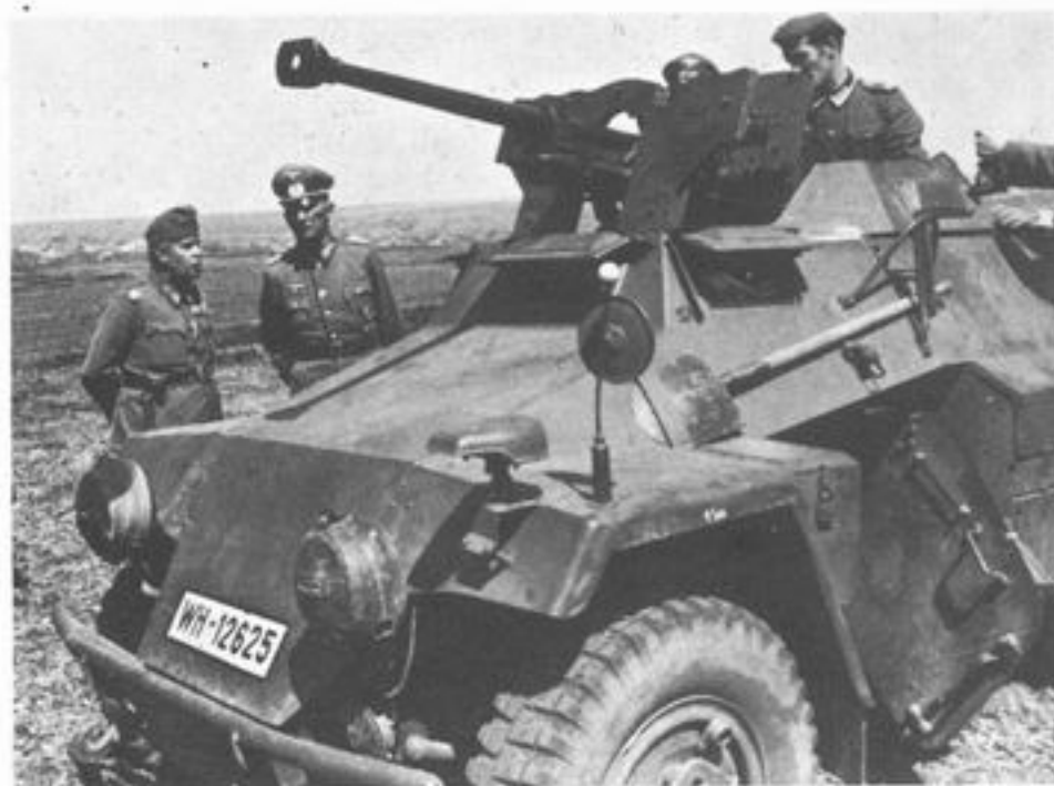
Leichter Panzerspähwagen SdKfz 221 mit 2,8cm Panzerbuechse 41 or 2,8cm sPzB 41 auf SdKfz 221
