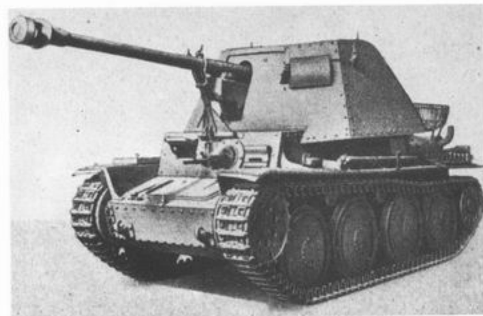
7,5cm Pak 40/3 (L/46) auf PzJaeg 38(t) SdKfz 138 or 7,5cm Pak 40/3 auf Sfl 38(t) Ausf. H or Panzerjaeger 38(t) Marder III
