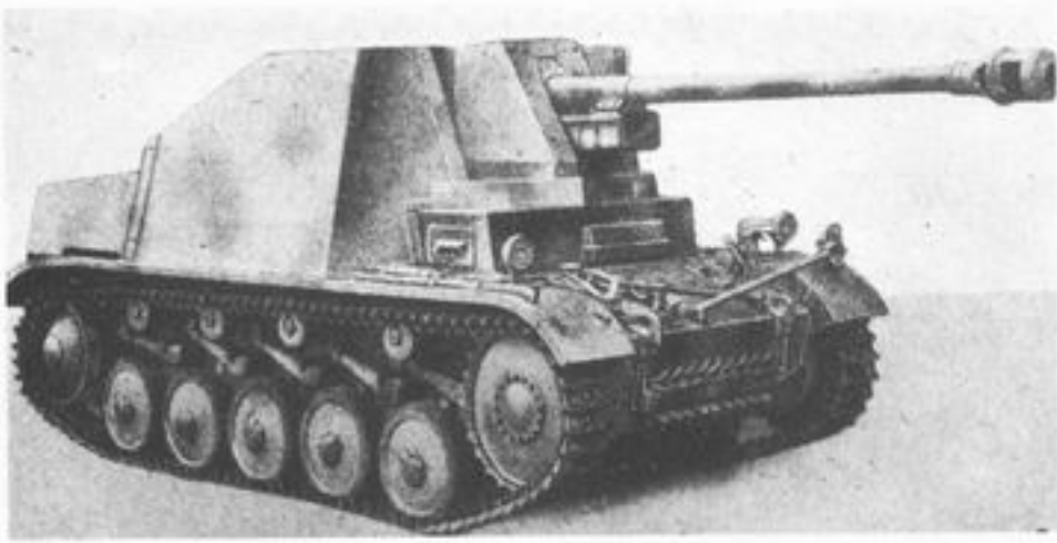
7,5cm Pak 40/2 auf Sfl II (Marder II) SdKfz 131 or PzJaeg II Ausf. A, C und F fuer 7,5cm Pak 40/2 L/46 or GW II fuer 7,5cm Pak 40/2 (Marder II)
